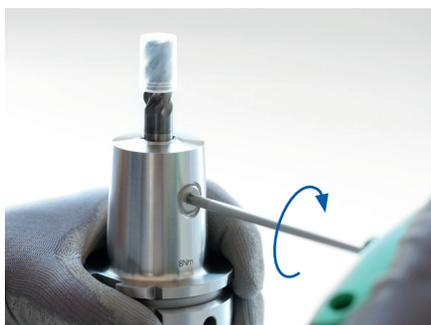
5. Einen Drehmomentschlüssel auf das angegebene Anzugsdrehmoment (siehe Tabelle "Anzugsdrehmomente der Spannschraube" auf Seite 7) einstellen.
