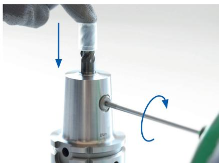
3. Das Werkzeug von oben andrücken. Gleichzeitig die Spannschraube im Uhrzeigersinn bis zum Anschlag drehen.
